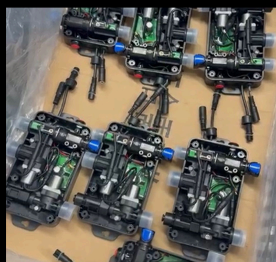
ETAP 3: Montaż modułów sterujących
